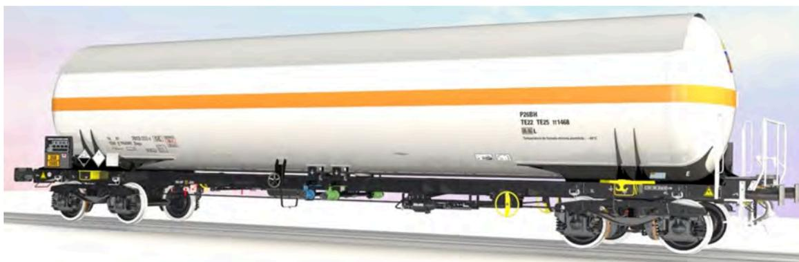
Bild: Bahnwaggon<sup>6</sup> für den Transport von 55t NH<sub>3</sub>
